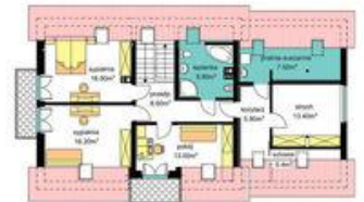
PODDASZE Pu 62,60m 2 , p podł. 77,50m 2 Pg 27,20m 2 , p podł. 46,40m 2
